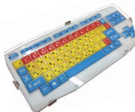
Клавиатура адаптированная с крупными кнопками + пластиковая накладная, разделяющая клавиши
